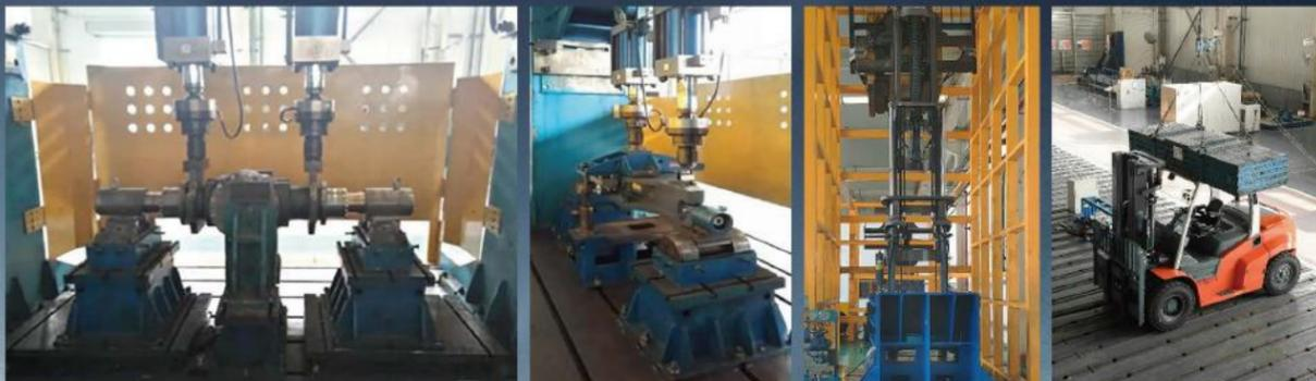
Prova di fatica dell'asse del motore.
