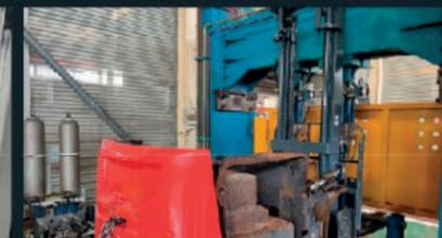
**Test di vibrazione del carrello**
