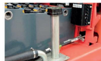
Il serbatoio dell'olio idraulico è situato sul lato sinistro per facilitare il riempimento e il controllo.
