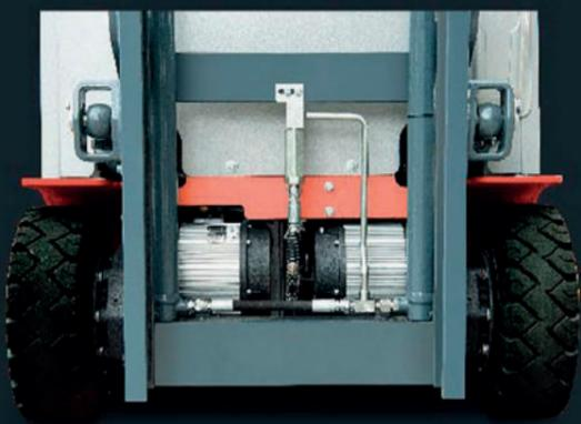
Prestazioni elevate, il carrello è dotato di unità di azionamento a doppio motore
