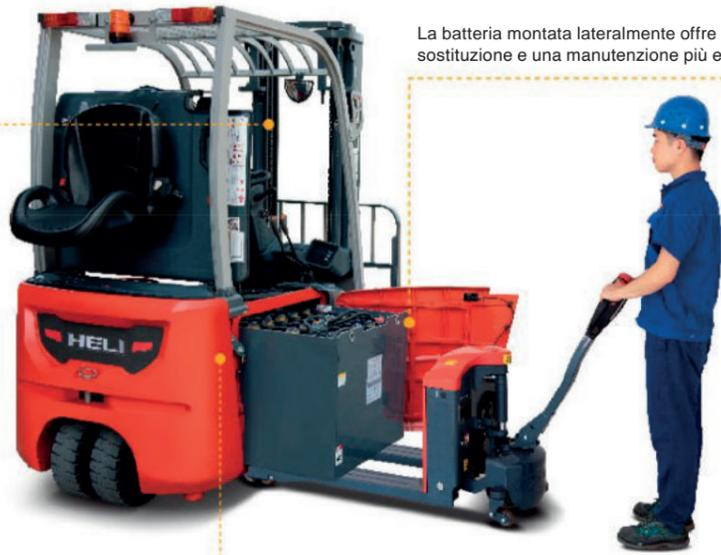
La batteria montata lateralmente offre una sostituzione e una manutenzione più efficienti.
