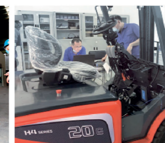
Test di vibrazione del carrello La frequenza di vibrazione dell'intero carrello viene testata per ottimizzare e migliorare il comfort operativo.
