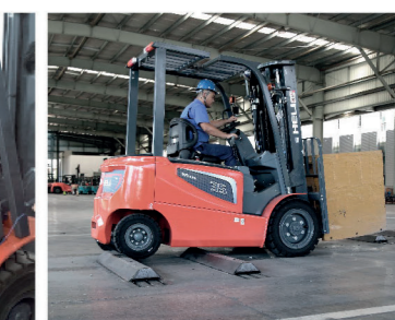
Test dell'affidabilità Rafforzamento di 800 ore dell'intero carrello (compresi arrampicata, pioggia, strada accidentata, ecc.)
