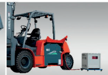
Interfaccia di ricarica rapida ad incastro
